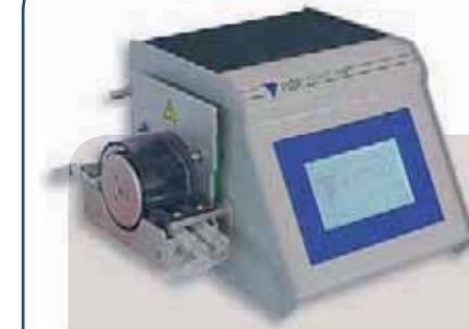
Специальный дозирующий насос DosiPump используют для добавления в приготовленные питательные среды термолабильных добавок (кровь -для приготовления кровяного агара, витамины, НАД, Гемин- для культивирования гемофильных бактерий и т.п..)
