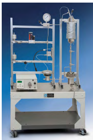
Модель 5400 с охлаждением продукта реакции.
