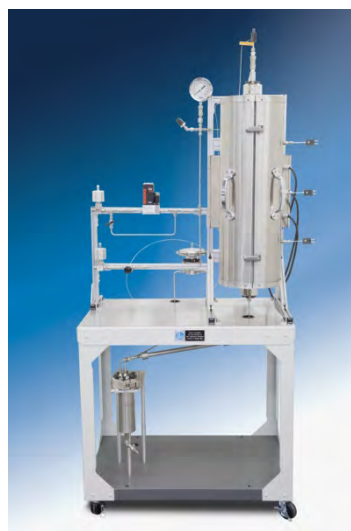
Модель 5403, трехзонный нагреватель, система подачи газа и жидкости.
