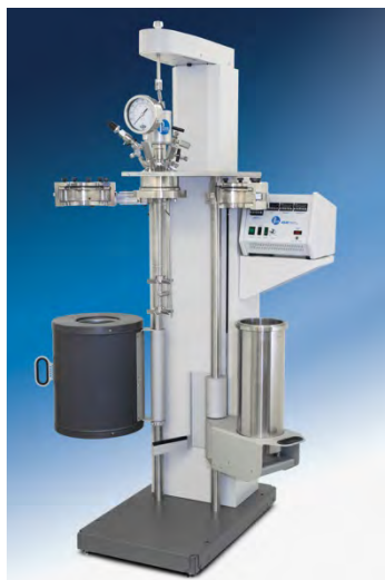
Модель 4554 реактора с фиксированной крышкой, сосуд 7.5 л, пневматический лифт, подвешенное сплит-кольцо, внутренние фитинги, серпантинный охлаждающий контур и контроллер 4848.
