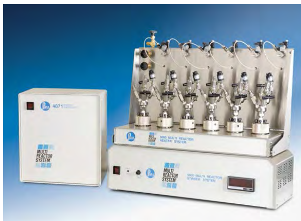
Модель 5000 мультиреакторной системы, 6 сосудов по 75 мл с плоским уплотнением, контроллер 4871.
