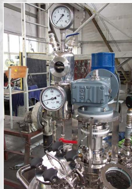
Механическое уплотнение вспомогательной системы
