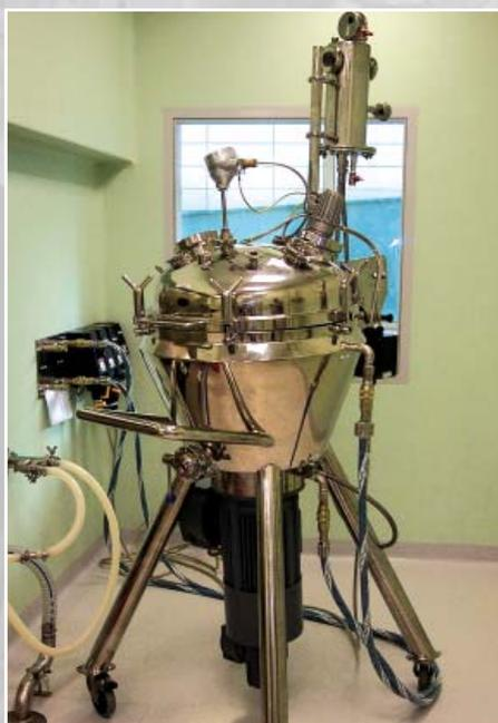
Мобильный реактор с проточным гомогенизатором
