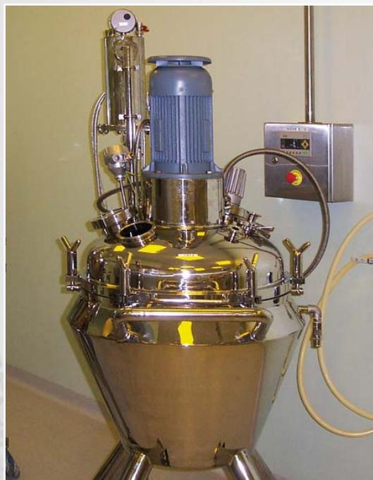
Конический смеситель с пропеллерной мешалкой во взрывобезопасном исполнении
