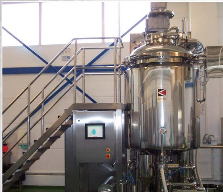
Реактор с проточным гомогенизатором
