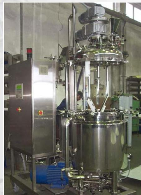
Реактор с проточным гомогенизатором, V=100 л
