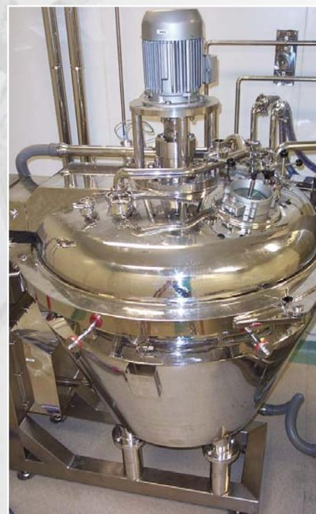
Конический смеситель с турбинной мешалкой
