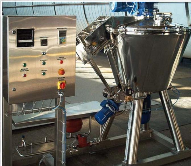
Конический смеситель с гомогенизатором и рамной мешалкой, оборудован электрическим нагревателем
