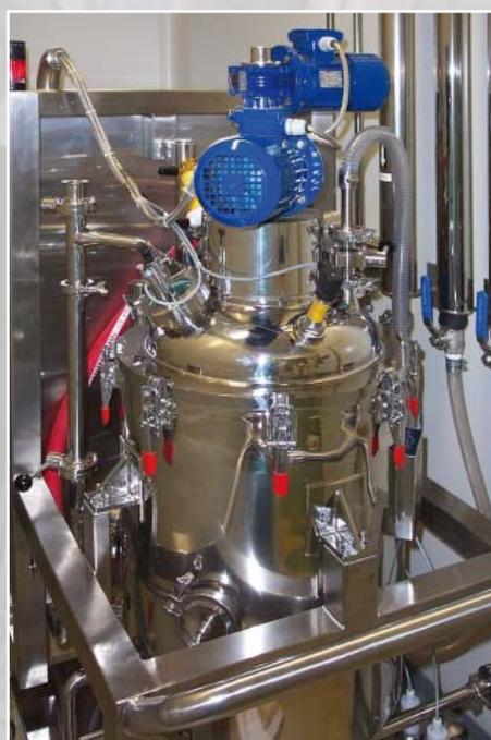
Реактор с проточным гомогенизатором, V=50 л
