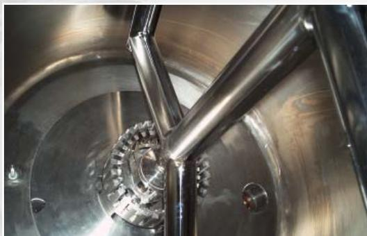
Рамная мешалка с диспергатором в днище емкости
